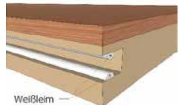
Bei Drop-Down wird die lange Seite wie oben eingewinkelt. Die Verriegelung der Enden erfolgt beim Herunterklappen und dosiertem Nachklopfen von oben auf das Kopfende. Eine zusätzliche Leimangabe ist auch hier möglich.
